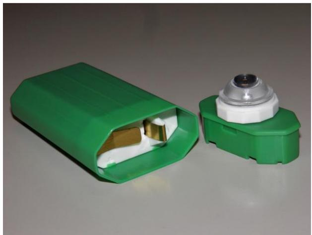
Retirer le couvercle de la batterie (éventuellement avec un couteau pointu)
